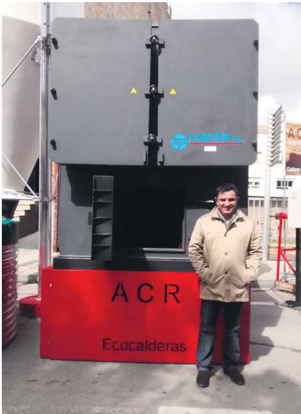
Vista frontal de la caldera de 1.000 kilovatios.
